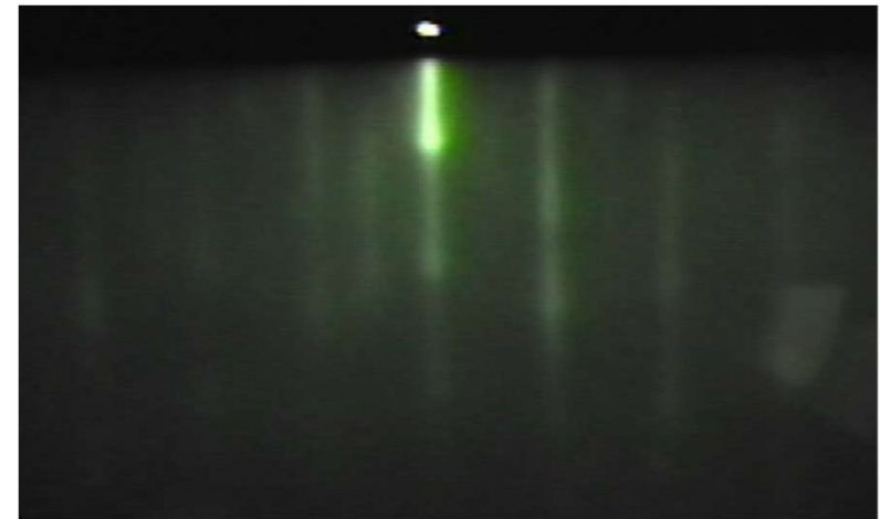
成長温度200°Cの際の電子線回折像
